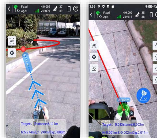
Los usuarios utilizan las imágenes en tiempo real capturadas por la cámara en la parte inferior del receptor y las líneas guía AR mostradas por el software para localizar los puntos objetivo.
